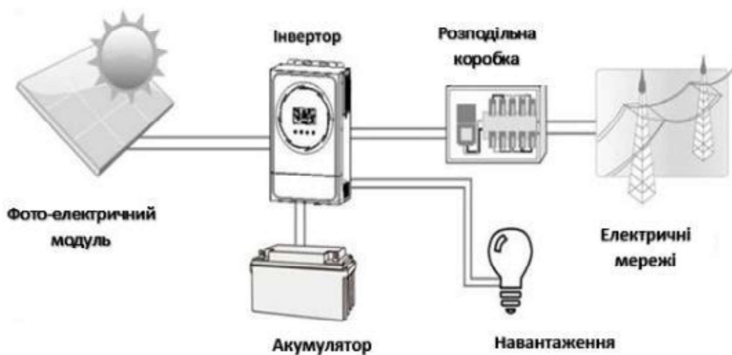
Малюнок 1 Загальний огляд фотоелектричної системи
