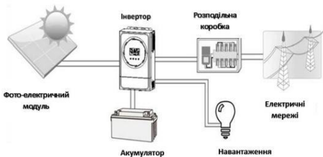
Малюнок 1 Загальний огляд фотоелектричної системи
