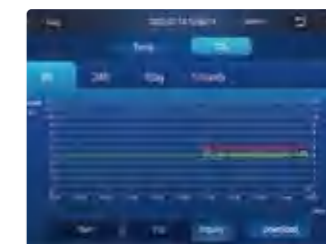
Отображение рабочих данных в режиме реального времени. Отображение температуры, концентрации CO 2 и O 2 в режиме реального времени. Позволяет просматривать концентрацию и данные в любое время в течение цикла инкубации.
